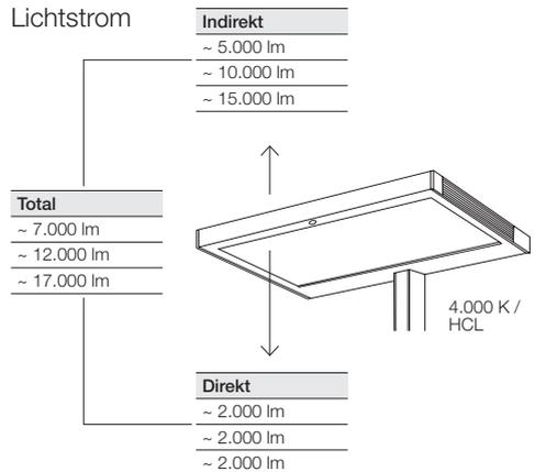
Modernste LEDs liefern über ein Lichtpanel entweder eine asymmetrische oder symmetrische Lichtverteilung. VITAWORK® ist für die Ausleuchtung größerer und tiefer Büroräume geeignet. Bei der Entwicklung wurde besonderer Wert auf die Energieeffizienz gelegt (ca. 135 lm/W). Abhängig vom Anwendungsfall erfüllt VITAWORK® die Anforderungen der DIN EN 12464-1 als auch der ASR 3.4.
